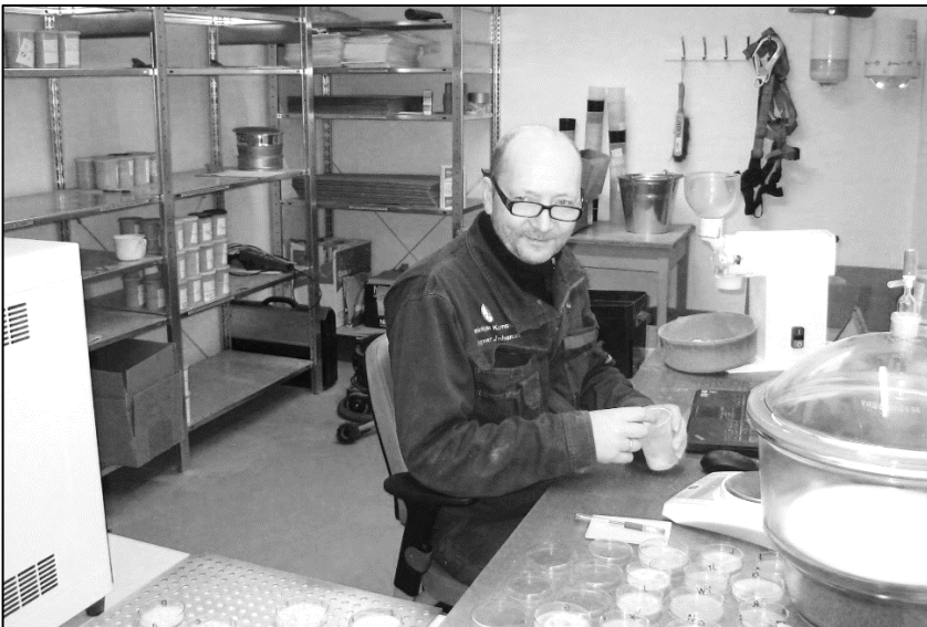
Magnar Johansen er veteranen i huset. Han har jobbet her siden september i 1977. Her forbereder han fuktighetsanalyser av kornprøver ved at det veies i prøveporsjoner a' 5 gram som tørkes ned i tørkeskap med veiing før og etter. Dette gjøres jevnlig for at vi til enhver tid skal vite hvor stor feilvisning den elektroniske fuktighetsmåleren gir.
